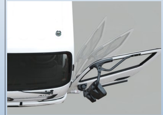
Kademeli Olarak 90° Açılabilen Güçlendirilmiş Yan Kapılar
